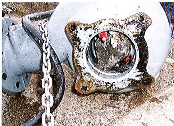
Intervention d'urgence sur une pompe – mécanisme bloqué par une accumulation de lingette- usure précoce du matériel
